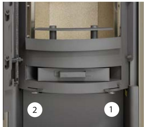
**Bild 3** Aschekasten, Primärluftschieber ① und Sekundärluftschieber ② im Bild offen dargestellt. Der Primärluftschieber steuert die Verbrennungsluftzuführung durch den Rost. Der Sekundärluftschieber regelt die Scheibenspülluft.
