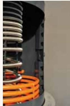
Der innenliegende Edelstahl-Wellrohr-Wärmetauscher ist besonders verkalkungsarm. Am Glattrohr-Wärmetauscher (orange) werden die Solarkollektoren angeschlossen.
